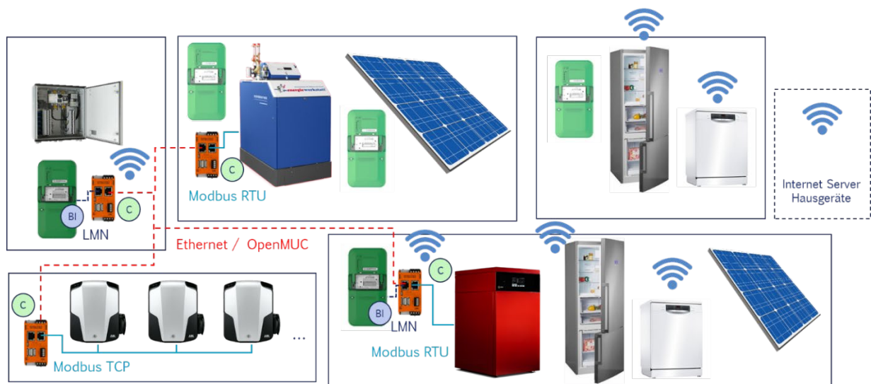
Abbildung 12: Ausgestaltung der IKT zur Gerätesteuerung in SoLAR
